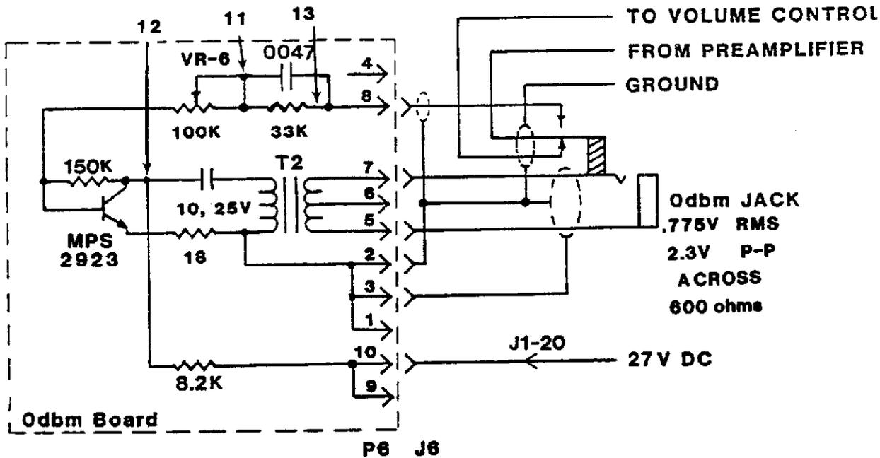
Figure 5-3. 0dbm CIRCUIT
