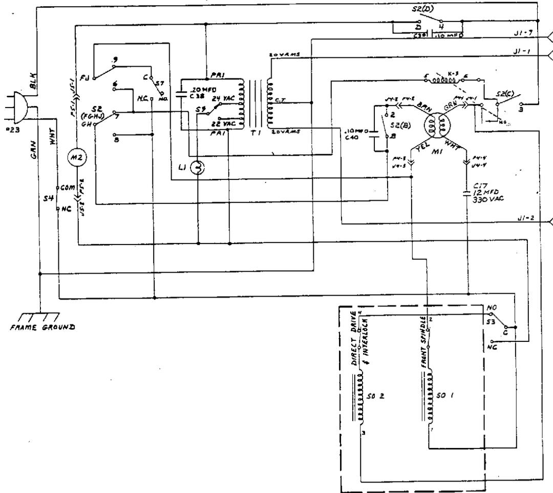
PROJECTOR SCHEMATIC DIAGRAM MODEL 2210
