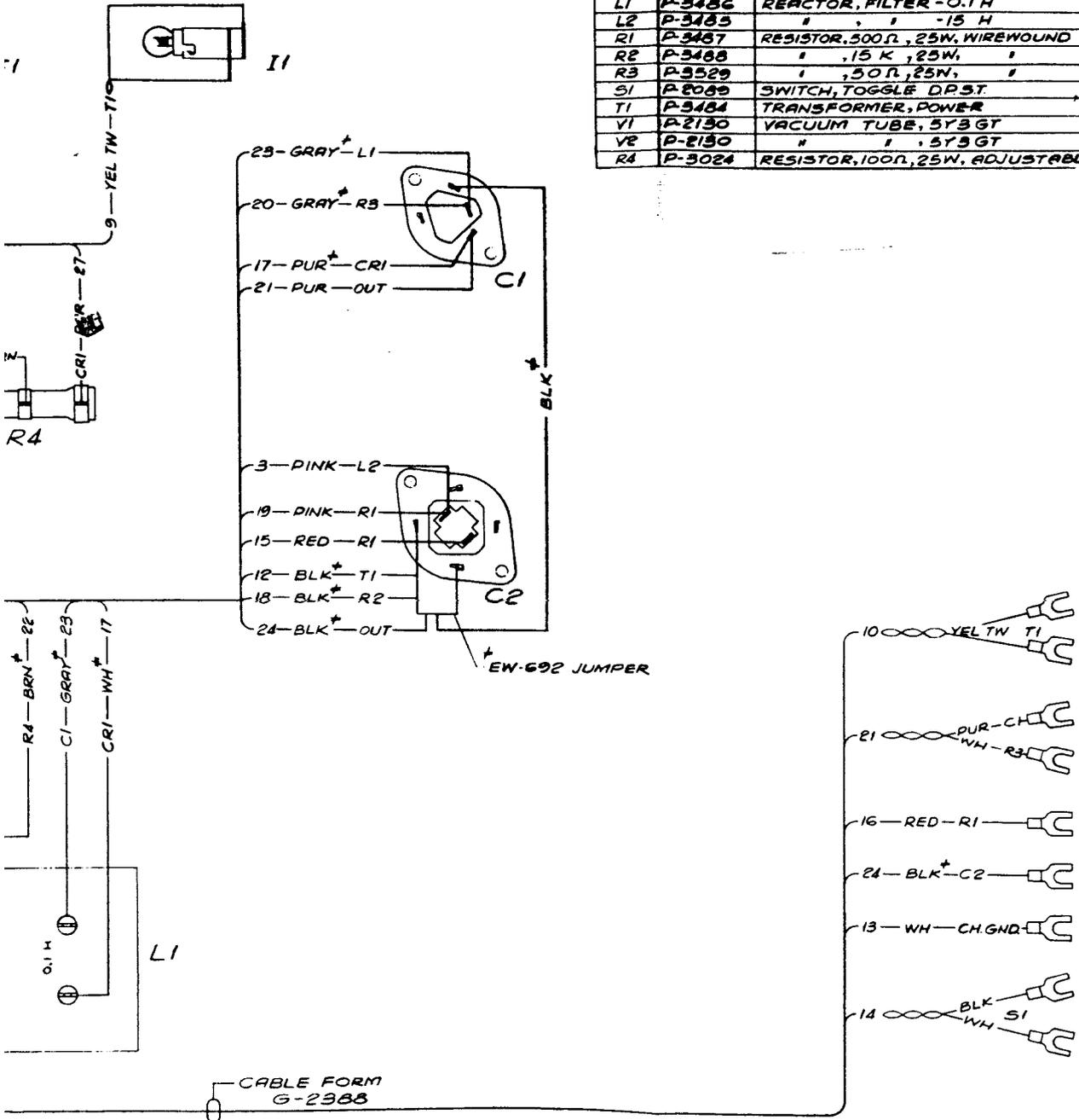
WIRES MARKED + ARE N° 20 AWG.
